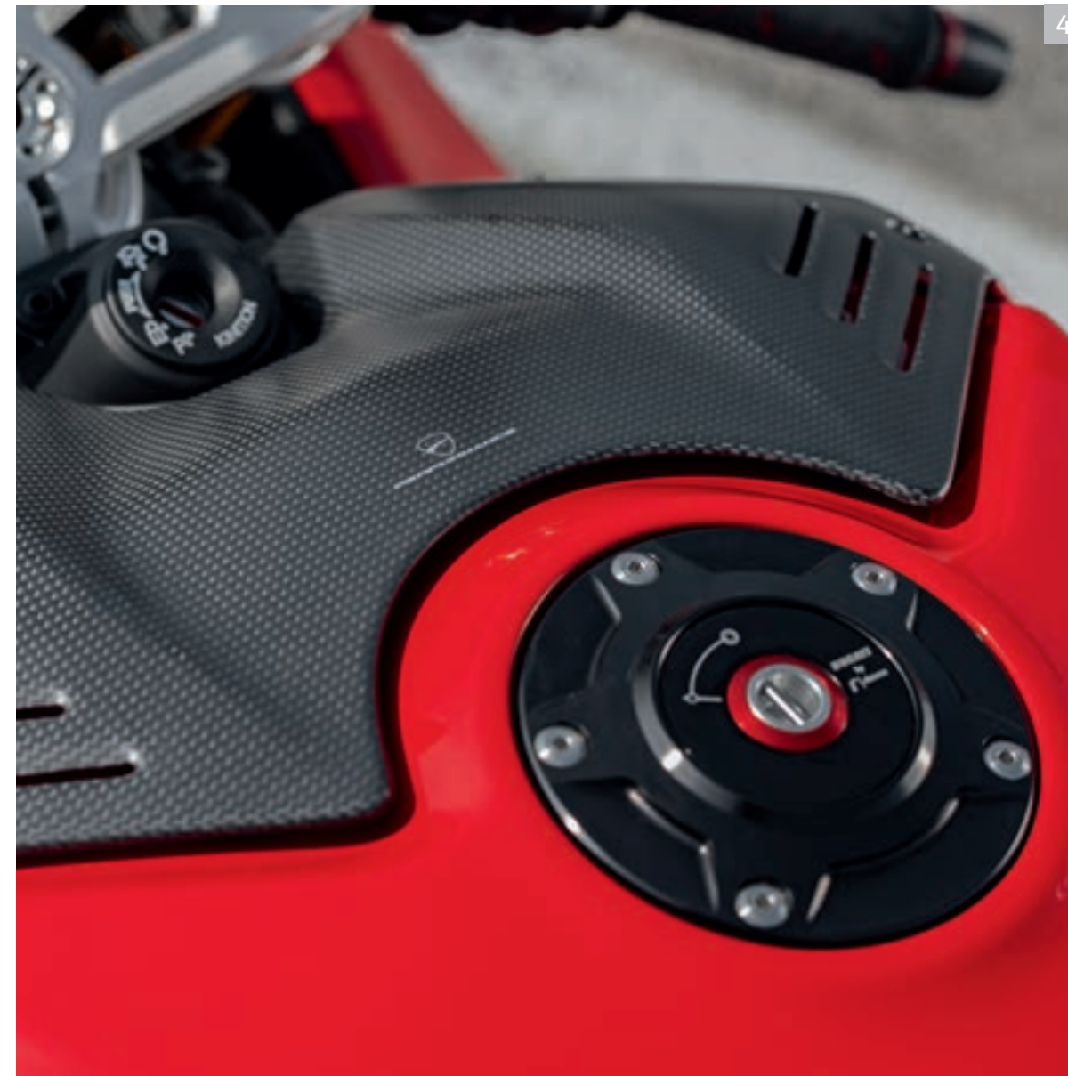
4 Cover serbatoio in carbonio. Tappo serbatoio in alluminio dal pieno
