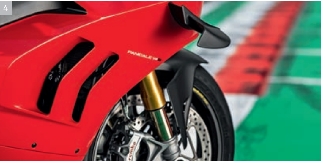
3 Sospensioni Öhlins a controllo elettronico Öhlins Smart EC 2.0
