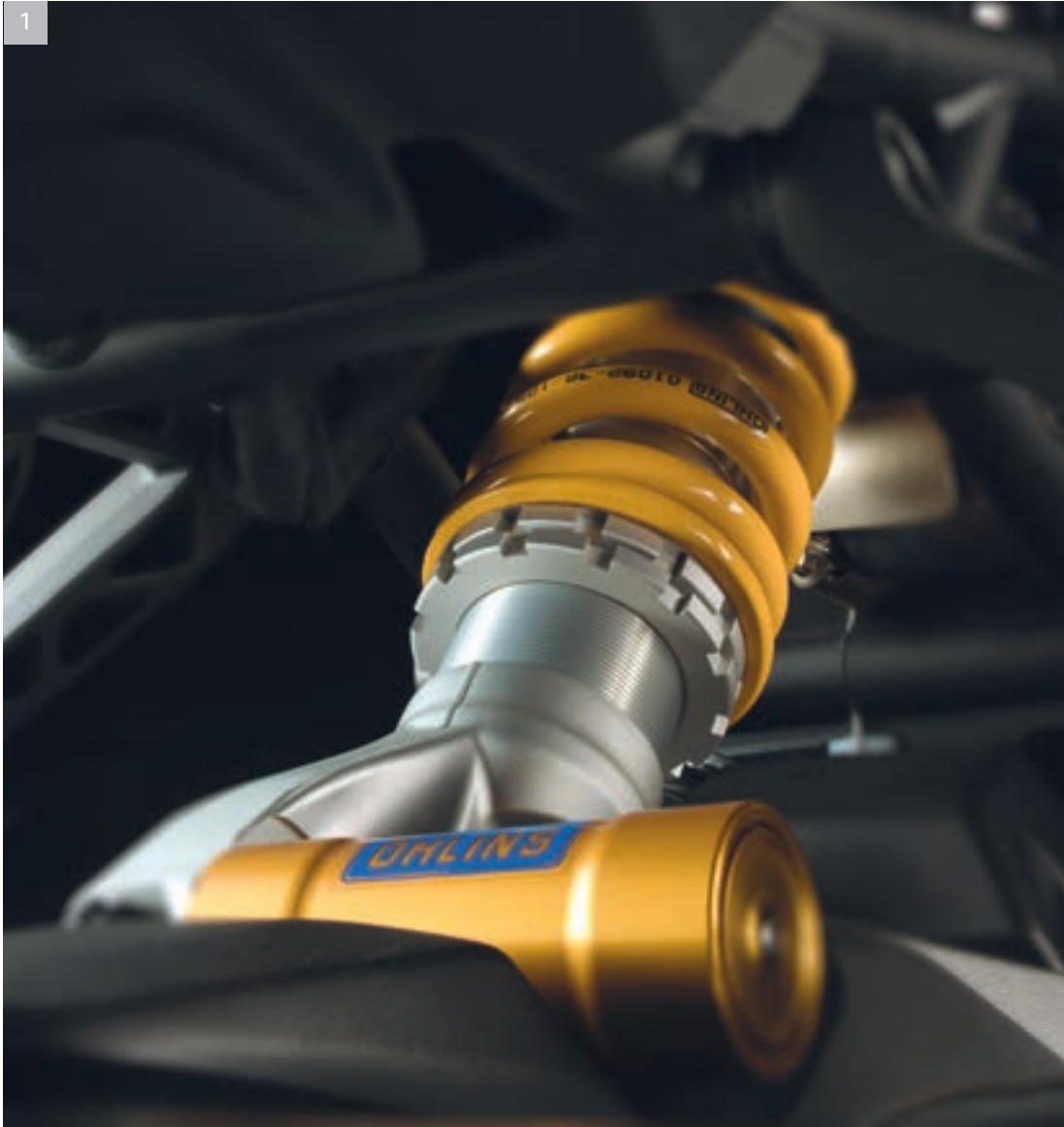
1 Suspensiones Öhlins completamente regulables delanteras y traseras
