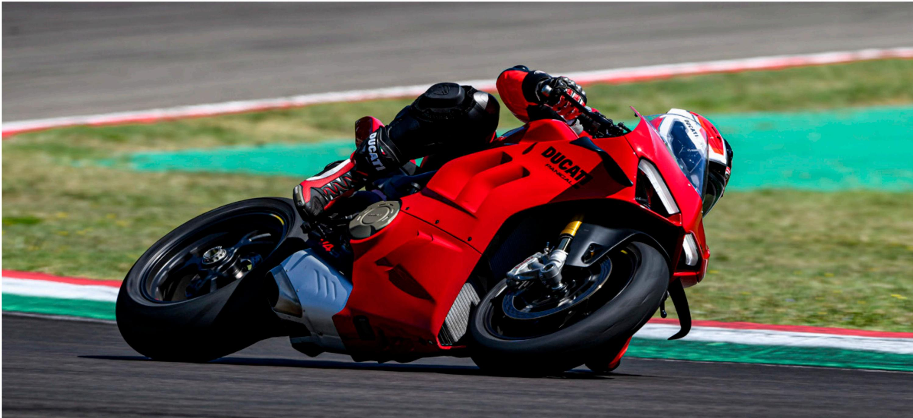
La Panigale V4 '22 utilizza una nuova configurazione di ala a 2 elementi, main e flap, concettualmente analoga a quella di un'ala posteriore di una vettura di Formula Uno. Le nuove ali sono più compatte del 40% e più sottili del 50% rispetto a quelle del modello precedente, pur garantendo il medesimo carico verticale, fino a 37 kg a 300 km/h.
