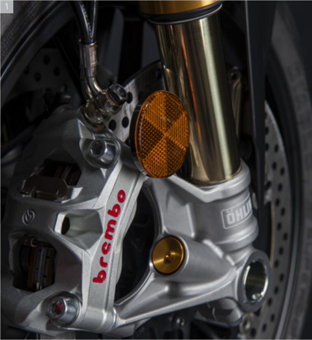
1 Forcella Öhlins NPX25/30 pressurizzata da 43 mm, event based
