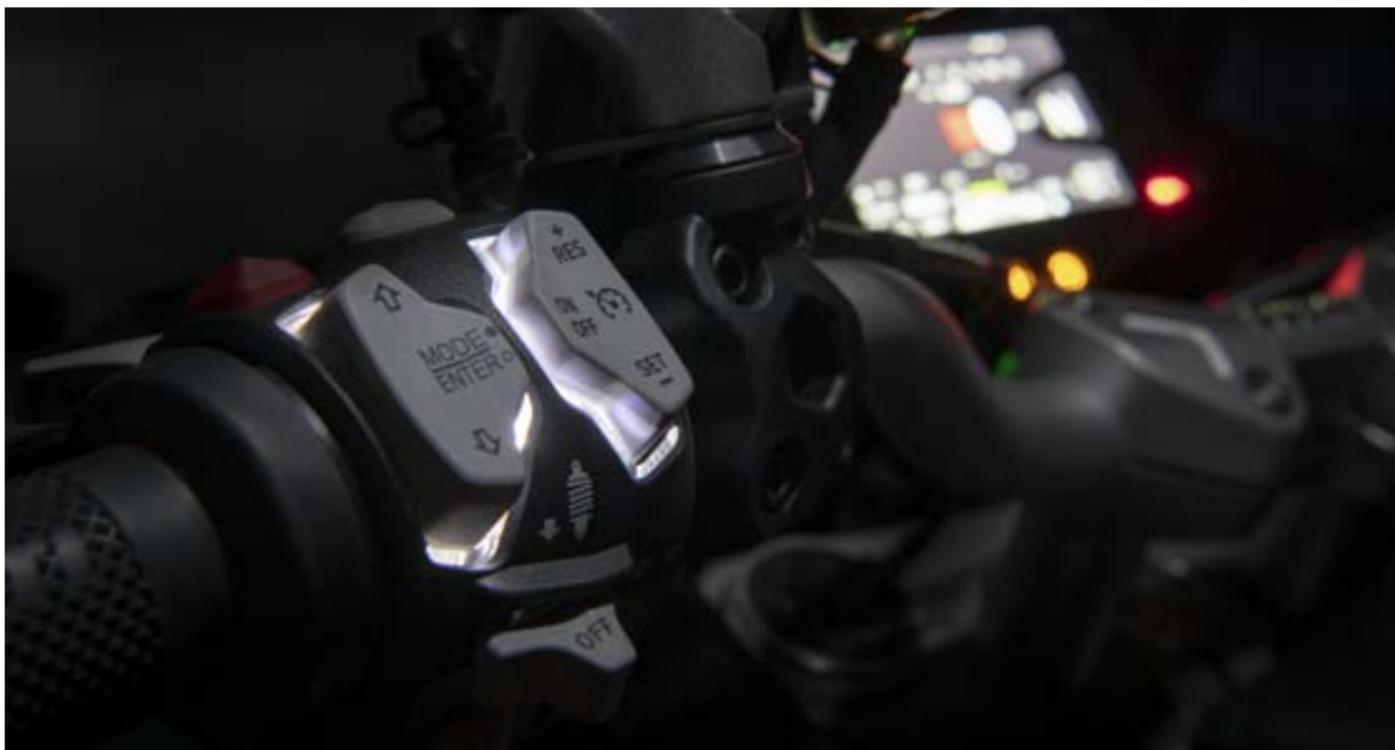
Il sistema Vehicle Hold Control (VHC) serve per aiutare il pilota nelle fasi di partenza in salita. Si attiva quando, con moto ferma e con cavalletto laterale retrato, l'utente applica una pressione elevata sul freno anteriore o posteriore: a quel punto il sistema elettronico mantiene ferma la Multistrada V2 intervenendo sul freno posteriore.
