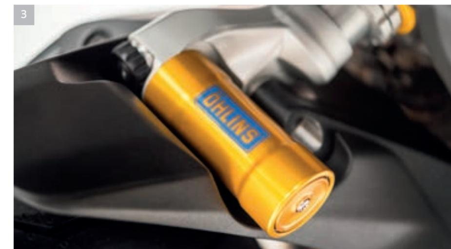
3 Mono-ammortizzatore Öhlins completamente regolabile con serbatoio integrato del gas.
