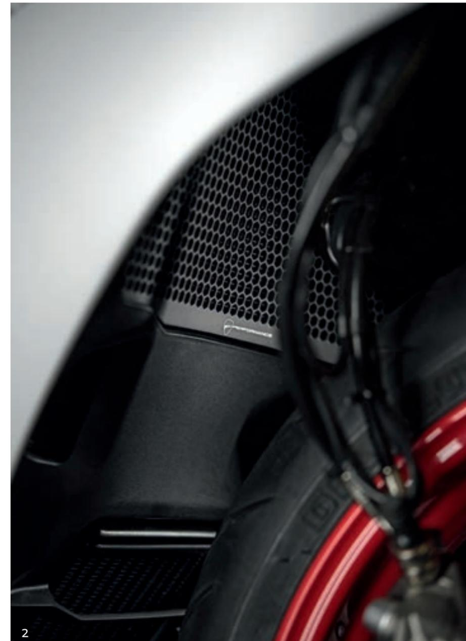
2\_ Rete di protezione per radiatore acqua. 3\_ Portatarga in alluminio.
