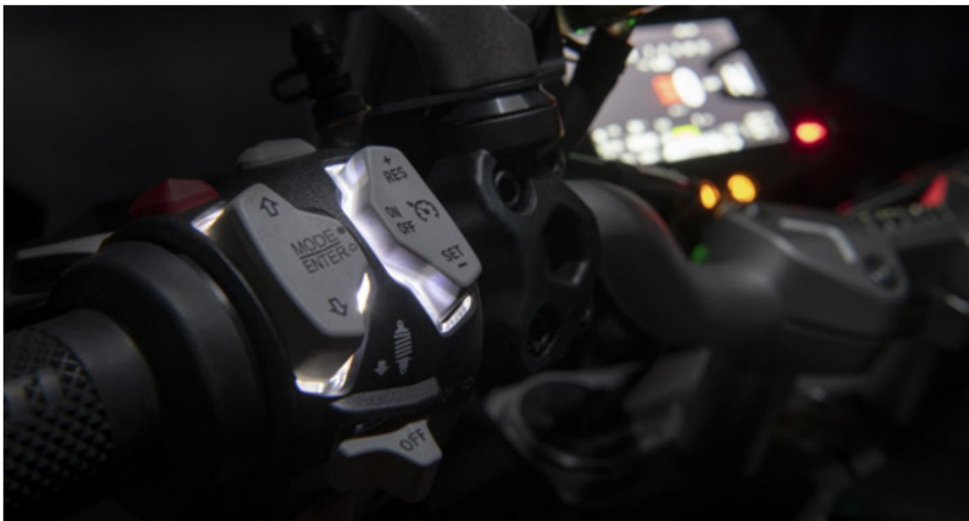
Il sistema Vehicle Hold Control (VHC) serve per aiutare il pilota nelle fasi di partenza in salita. Si attiva quando, con moto ferma e con cavalletto laterale retractor, l'utente applica una pressione elevata sul freno anteriore o posteriore: a quel punto il sistema elettronico mantiene ferma la Multistrada V2 intervenendo sul freno posteriore.
