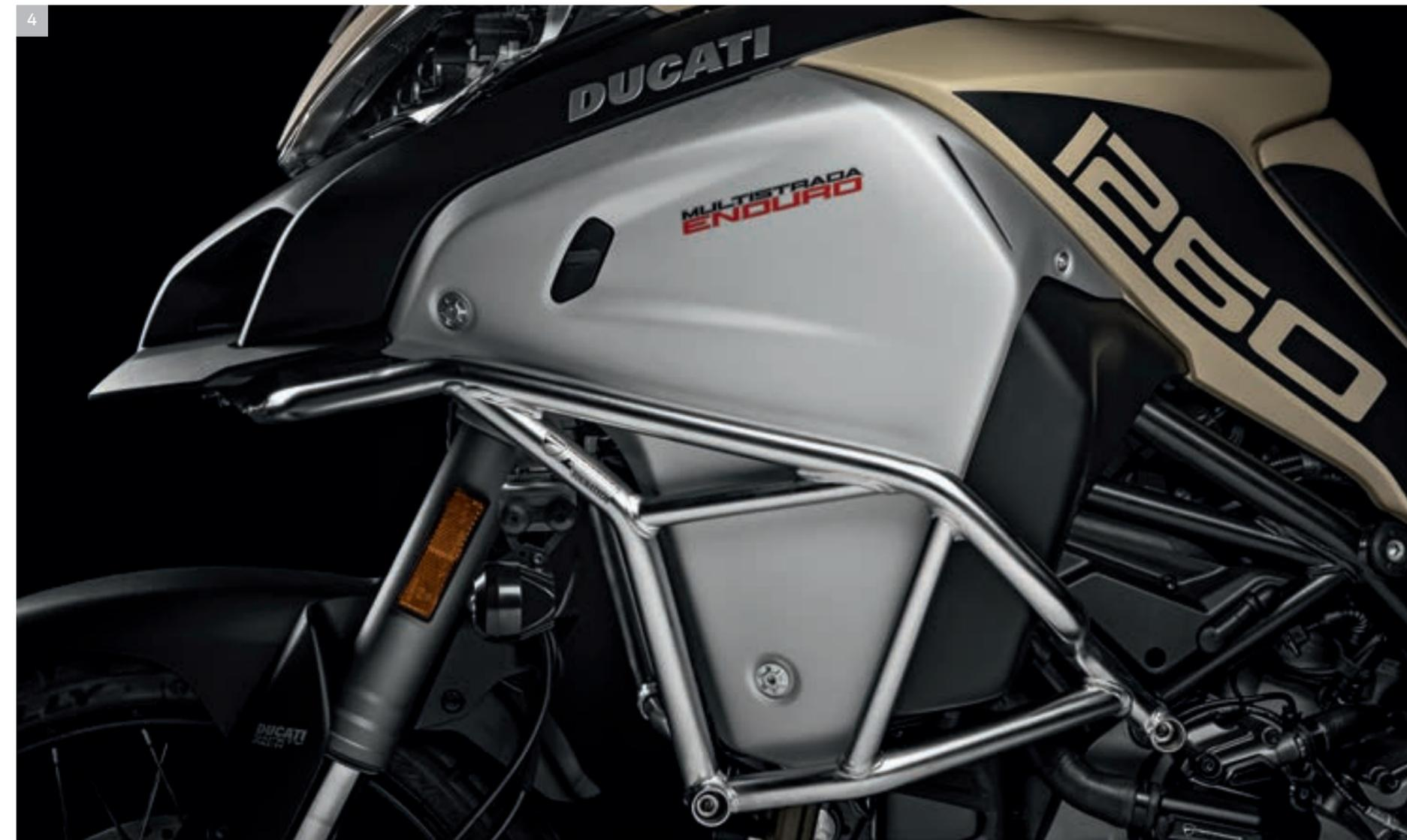
4 Protezioni laterali serbatoio in tubi d'acciaio.
