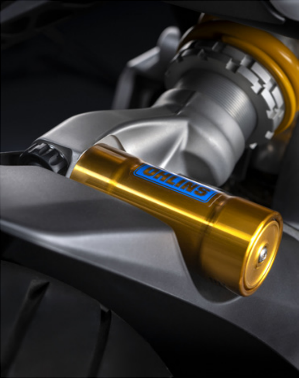
2 Mono-ammortizzatore Öhlins completamente regolabile con serbatoio integrato del gas.
