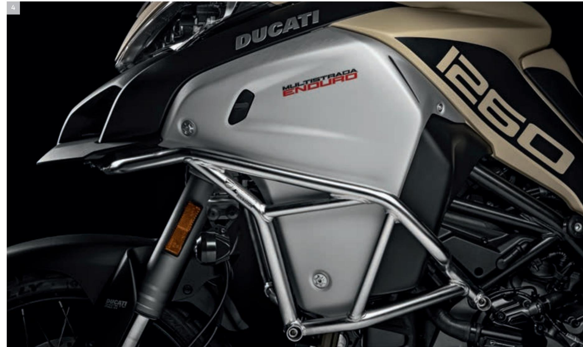
4 Protections latérales du réservoir en tubes d'acier
