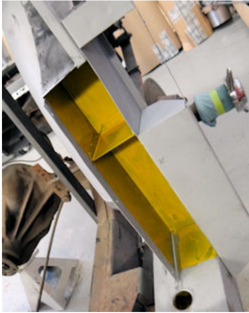
Wurth Body Wax applied inside B pillar
