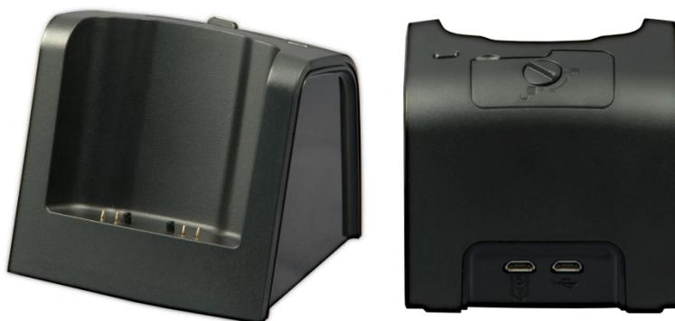
Telefon auf die Station stellen. USB-Kabel an der 5V-Buchse der Tischstation anschließen. Anderes Ende des USB-Kabels am Netzteil anschließen. Netzteil in eine Steckdose stecken.
