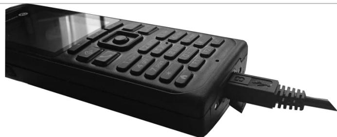
USB-Kabel den USB-Anschluss des Telefons anschließen. Das andere Ende des USB-Kabels am Netzteil oder einem USB-Anschluss anschließen.
