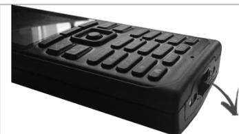
USB-Kabel den USB-Anschluss des Telefons anschließen. Das andere Ende des USB-Kabels am Netzteil oder einem USB-Anschluss anschließen.
