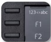
Das DeskPhone 8018 verfügt über drei vorprogrammierte Tasten für den Zugriff auf bestimmte Funktionen. In diesem Fall wird das Funktionssymbol auf das Papier gedruckt. Drücken Sie auf die entsprechende Taste, um die Funktion zu verwenden. Nach der Aktivierung bleibt die LED der entsprechenden Taste erleuchtet. Drücken Sie zum Deaktivieren auf die entsprechende Taste.
