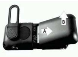
Falls der Gürtelclip angebracht ist, diesen zum Einlegen oder Austauschen des Akkus abnehmen. Der Gürtelclip kann auch nach links gedreht werden.
