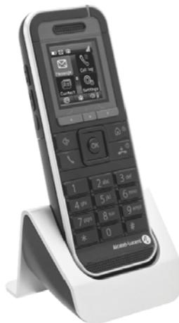
Telefon auf die Station setzen. USB-Kabel an der 5-V-Buchse der Tischstation anschließen. Anderes Ende des USB-Kabels am Netzteil anschließen. Netzteil an eine Netzsteckdose anschließen.
