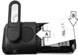
Positionieren Sie die Akkuanschlüsse seitlich (wie in der Abbildung gezeigt) (A). Schließen Sie die Installation des Akkus ab, indem Sie ihn wie in der Abbildung gezeigt in das Akkufach drücken (B).
