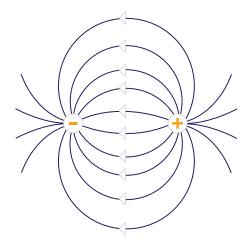
**Entstehung:** Ein elektrisches Feld entsteht zwischen zwei unterschiedlich elektrisch geladenen Materialien. Hierzu ist kein Stromfluss erforderlich.
