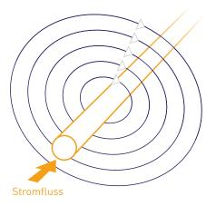
**Entstehung:** Ein magnetisches Feld wird durch bewegte elektrische Ladungen hervorgerufen, was einem Stromfluss in einem elektrischen Leiter entspricht. Die Stärke des magnetischen Feldes ändert sich proportional zur Stromstärke.
