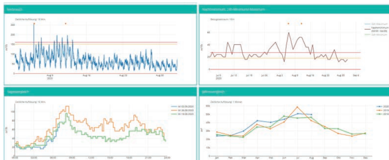
Das Wasser-Netz-Analyse Tool unterstützt bei der Detektion von Leckagen
