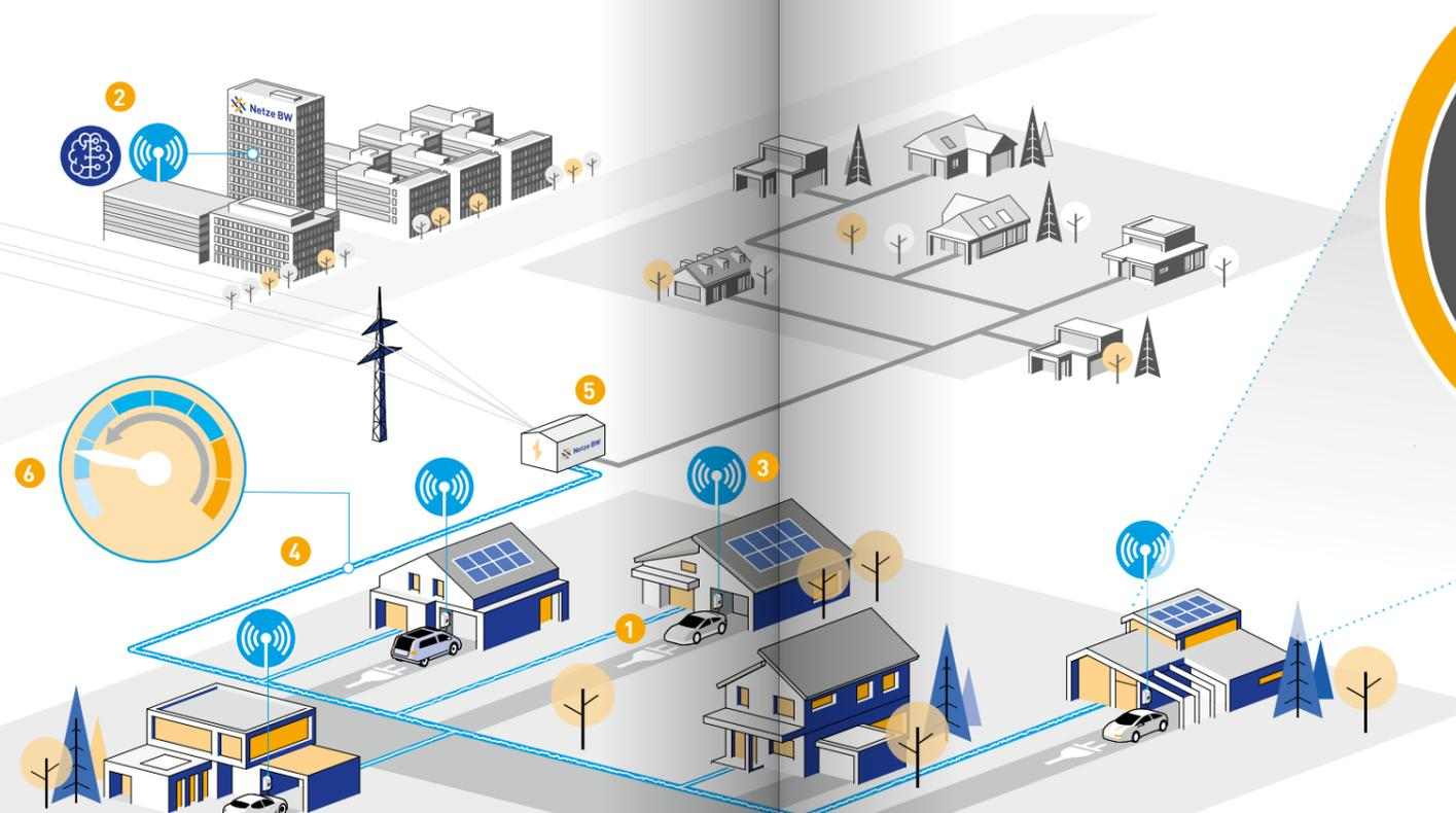
Abbildung 6: Schematischer Aufbau einer typischen Straße im NETZlabor Intelligentes Heimpladen mit der kommunikativ angebotenen Mess- und Steuerinfrastruktur
