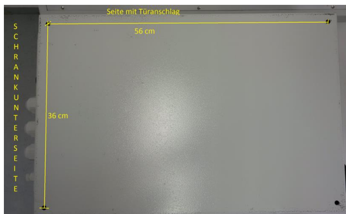
Abbildung 1 Position der Bohrungen zur Wandmontage
