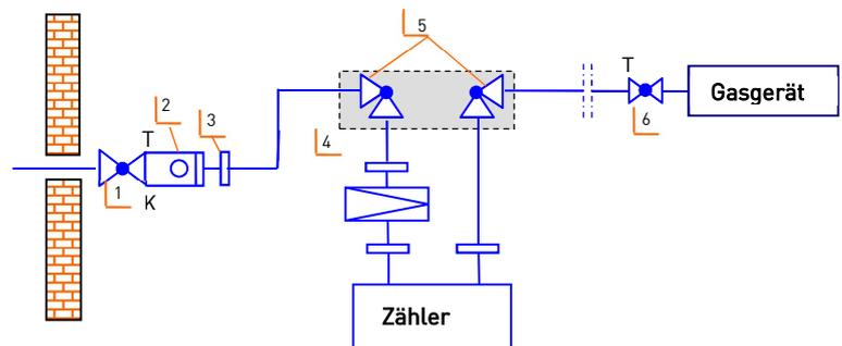
Es müssen GS Typ K mit integrierter oder kombinierter TAE verwendet werden. Das heißt beide Bauteile müssen metallisch wärmeleitend verbunden sein.
