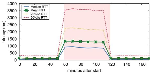
(d) Experiment I: 90% packet loss (60s TTL)
