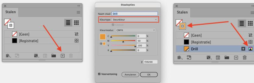
Pour les trous de perçage, faites un dessin au trait en forme de cercle d'un diamètre minimum de 4 mm et d'un diamètre maximum de 9 mm. Veillez à ce que le trou de perçage se trouve toujours à minimum 10 mm du bord. Donnez à cette ligne la couleur **Drill**.
