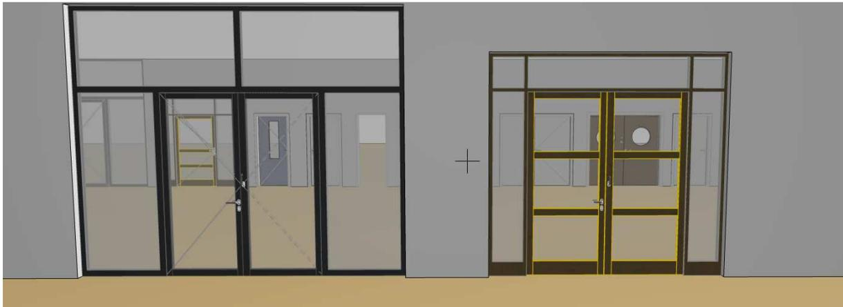
Rohrrahmentür Heroal D 82 SP und Holz-Rahmentür in Einzelanfertigung
