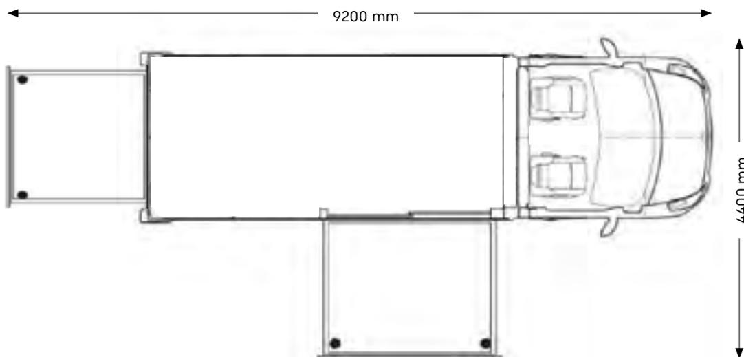
Die minimal benötigte Fläche zum Aufbau des Fahrzeugs beträgt in der Länge 9,20 m (mit geöffneter Heckklappe) sowie in der Breite 4,40 m (mit geöffneter Seitenklappe). Die angegebenen Masse berücksichtigen nicht den Platz der zum Einparken benötigt wird. Die Zufahrtsstrasse müssen aus einem harten, stabilen und ebenen Untergrund bestehen. Der Parkplatz muss ein Gesamtgewicht von ca. 3.500 kg tragen können.
