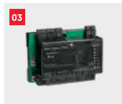
Zutrittsmanager 92 00 Eine leistungsfähige Steuerung für alle zeitgemäßen Sicherheitskonzepte, verwaltet und steuert je nach Systemlösung bis zu 12 Türen.
