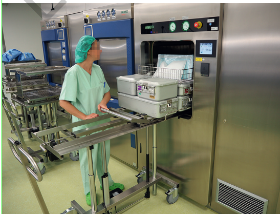
Abb. 4.1 Beladeseite Dampfsterilisator: Beschickung des Sterilisators [P1291]
