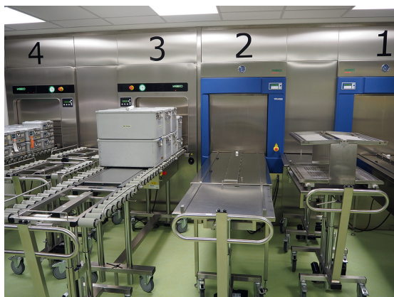
Abb. 4.2 Entladeseite Dampfsterilisationsapparat mit automatisierter Entladevorrichtung (sterile Seite) [P1291]
