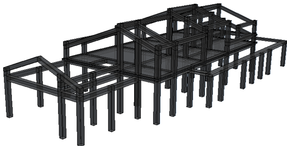
MODEL STRUCTURAL 3D: VEDERE SUD-VEST
