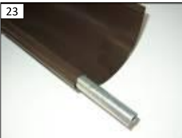
23 Montáž dvojdielnej spojky začneme nasunutím výstuhu do predného návalku až po zarážku v strede výstuhu
