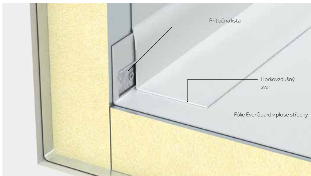
Obr. 2: Ukončení na prostupující konstrukci pomocí přítlačné lišty
