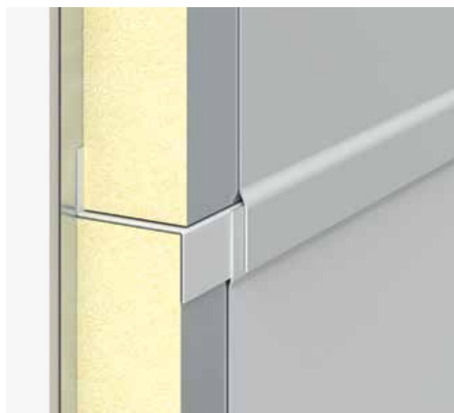
Obr. 8: Stabilizace Z profilem z fóliového plechu
