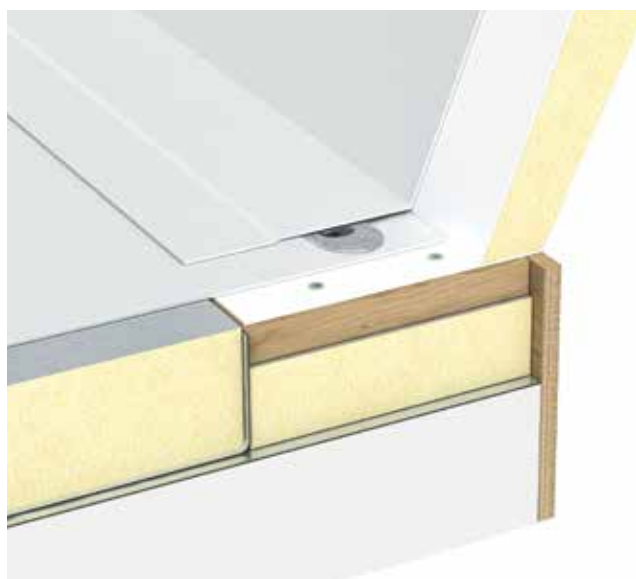
Obr. 10: Detail ukončení hydroizolační vrstvy u světlíku
