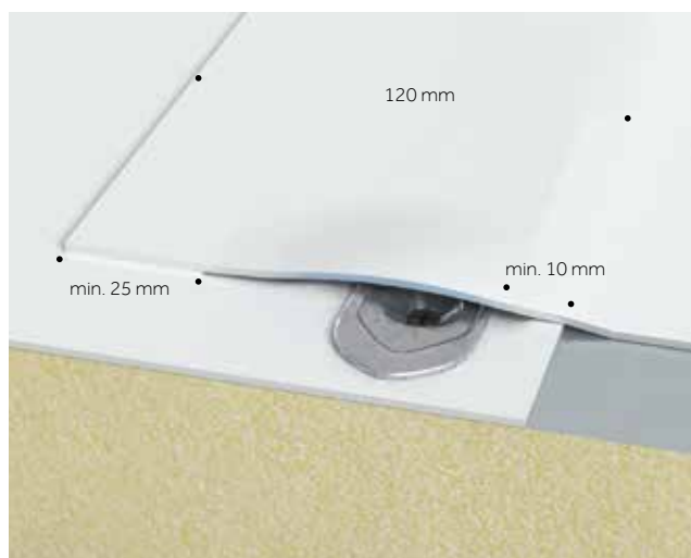
Příklad podélného spoje s ocelovou podložkou
