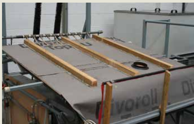
Test vodotesnosti fólie TOP RU pri dlhodobom pôsobení vody
