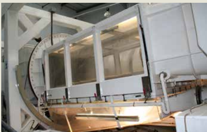
Simulácia hnaného dažďa na krytinu Bramac Max 7° - monitoring priekasu vody cez krytinu
