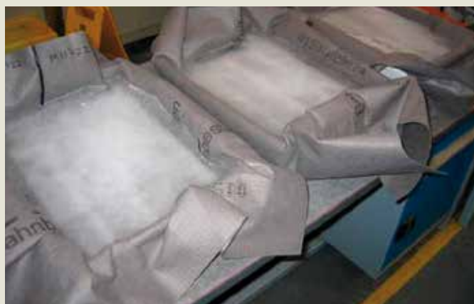
Test odolnosti fólie TOP RU a jej lepených spojov voči pôsobeniu ľadu
