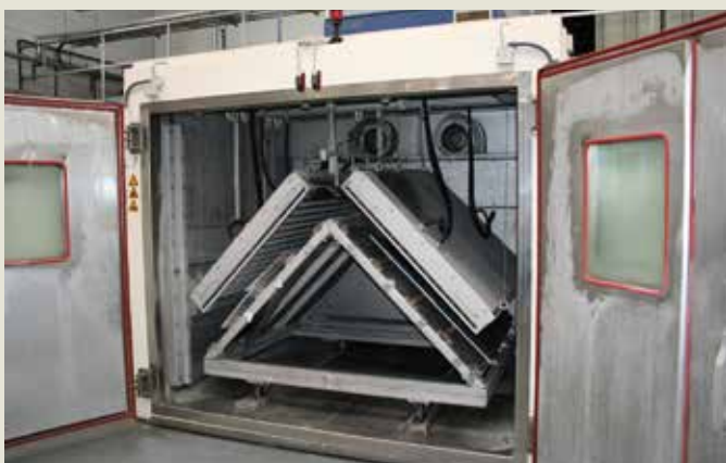
Pôsobenie UV žiarenia pri striedaní plusových (+ 20 °C) a minusových (- 20 °C) teplôt
