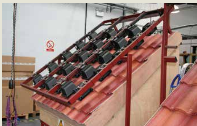
Test odolnosti povrchu škridly voči účinkom tepla (+ 80 °C)
