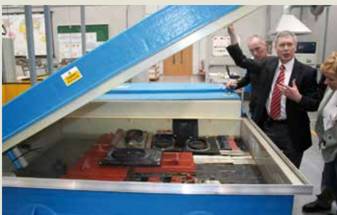
Simulácia pôsobenia vysokej teploty a vlhkosti na doplnky ku krytine Bramac Max 7°
