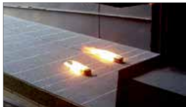
Průběh zkoušky typu B ROOF (t3)
