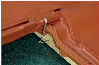
Slouží pro zajištění tašek proti účinku větru. Počet a rozmístění příchytek závisí především na zeměpisné poloze budovy, výšce budovy, sklonu a tvaru střechy, typu krytiny a únosnosti příchytky.
