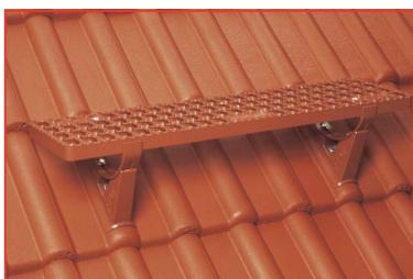
Požadavek na bezpečný pohyb po střeše splňují stoupací plošiny. Povrch plošin je navržen jako protiskluzový, neumožňuje shromažďování vody a minimalizuje hromadění sněhu. Plošiny splňují požadavek normy ČSN EN 516 – Prefabrikované příslušenství pro střešní krytiny – Zařízení pro přístup na střechu – Lávky, plošiny a stupně.
