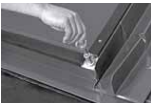
Îndepărtarea cârligelor de ancorare
