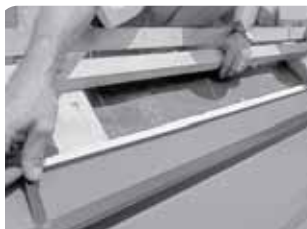
Montajul profilului din aluminiu
