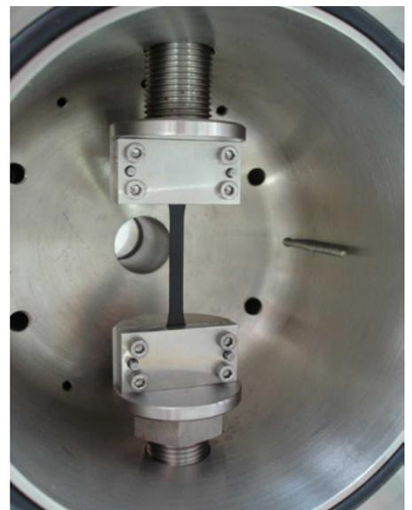
Enceinte sous pression d'hydrogène avec éprouvette de traction.
