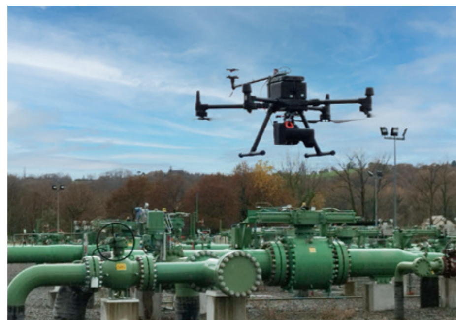
Mesures par drone des émissions de gaz « site level ».
