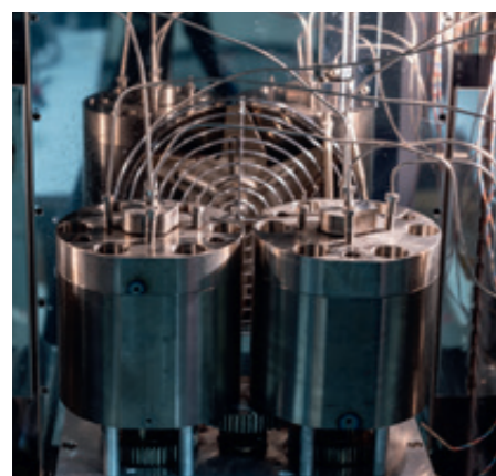
Banc de test de corrosion* du projet CorrO 2 dans le laboratoire de LaTEP à l'UPPA. Cette photo illustre l'intérieur d'une étuve contenant 2 autoclaves. Les étuves, construites en Hastelloy C276, sont munies de capteurs de pression et de température permettant de simuler les conditions des réservoirs.
