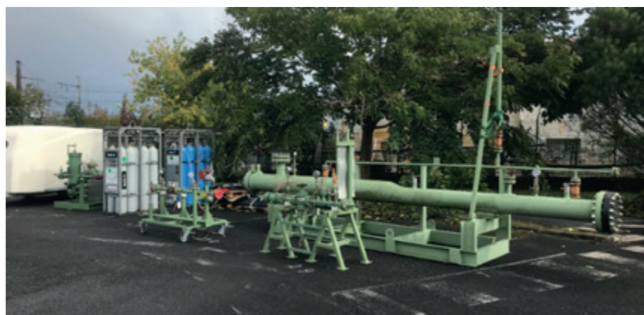
Banc test à l'hélium pour mieux connaître le comportement de nos installations vis-à-vis de l'Hydrogène.
