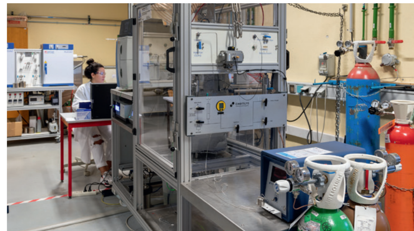
Réacteur et ses organes de contrôle (température, pression, chromato...).
