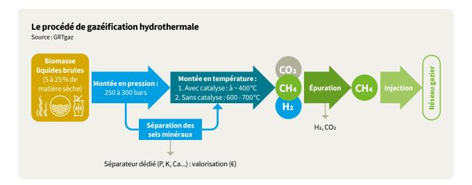
La gazéification hydrothermale est un procédé thermochimique à haute pression et haute température (400 à 700 °C) pour convertir des biomasses liquides présentant de faible taux en matière sèche (entre 5 et 25 %) en un gaz de synthèse riche en méthane qui, après épuration, peut être injecté dans les réseaux de gaz. La gazéification hydrothermale permet de valoriser :
